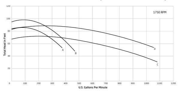
A. 65/250 (Ø 225mm) - 7.5 HP S.F. 1.25 B. 65/250 (Ø 240mm) - 10 HP S.F. 1.25 C. 100/250 (Ø 220mm) - 15 HP S.F. 1.25 D. 100/250 (Ø 240mm) - 20 HP S.F. 1.25
